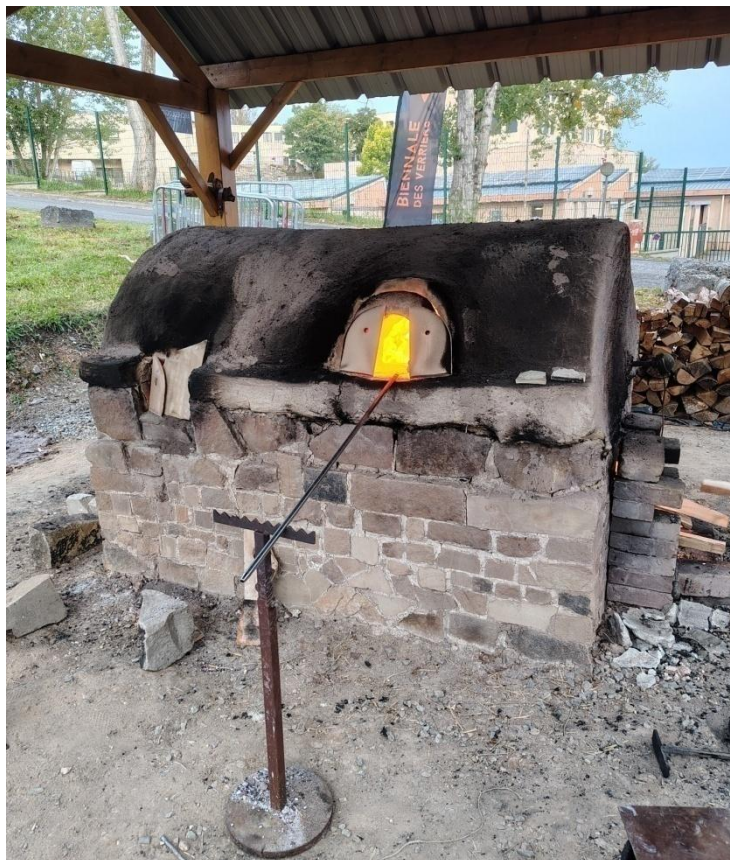
Figure 3 : Four de travail du verre en cours de chauffe, Domaine de la Verrerie, Carmaux. © I. Pactat.
